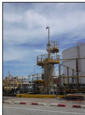
รูปที่ 3-14 Scrubber ที่ Sulfur Tank
